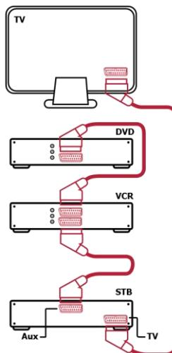
**На заметку!** ТВ-приставка оборудована дополнительным разъемом SCART VCR. Он позволяет последовательно соединить друг с другом ТВ-приставку и все видеоустройства (например: DVD-проигрыватель, видеомагнитофон), что позволит избежать необходимости подключать каждое устройство к телевизору по отдельности.
